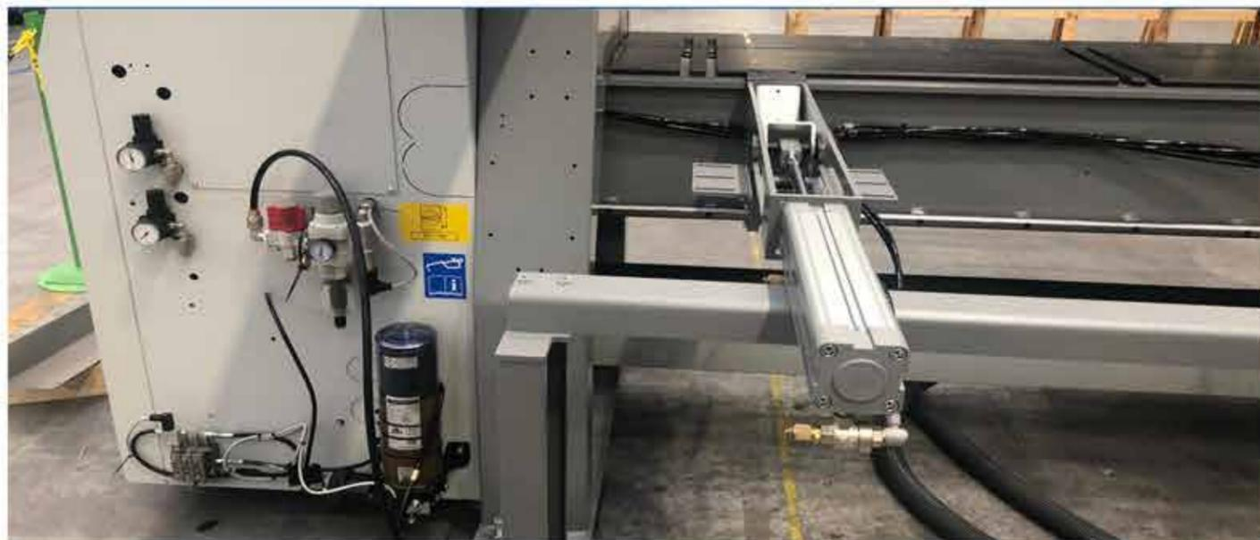
L'utilizzo di sistemi di lubrificazione è indispensabile per il corretto funzionamento delle macchine ancor di più quando queste lavorano in condizioni ambientali difficili come quelle della carta e legno. L'installazione di un sistema di lubrificazione automatico consente di ridurre i fermi macchina, controllare il consumo di lubrificante e aumentare la vita di cuscinetti, catene e ingranaggi.
